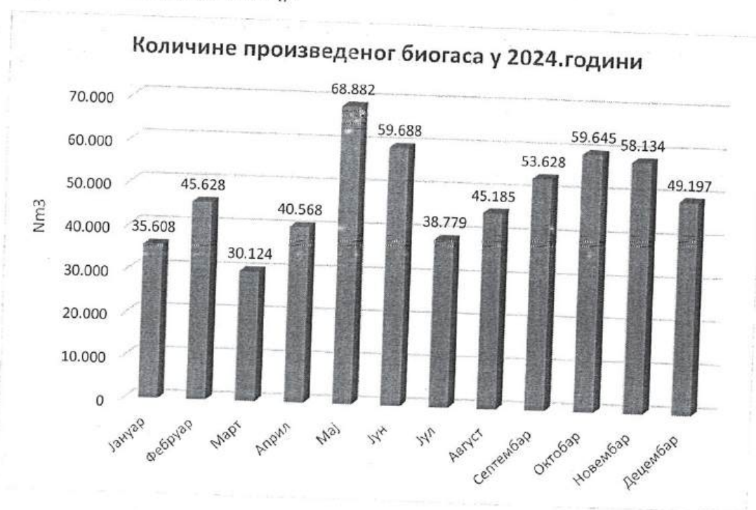
Графички приказ 6. Годишња продукција биогаса на ППОВ На бакљи је сагорело 14.311 Nm 3 , док је за грејање дигестора - рад котла потрошено 103.096 Nm 3 , са највећом количином од 26.403 Nm 3 у Фебруару.
